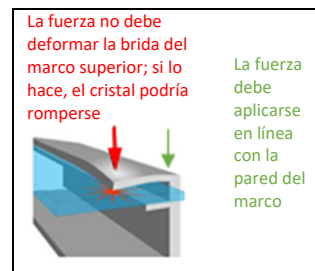
Figura 1a: Ubicaciones de fuerza de abrazaderas
